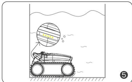
Sobald die Reinigung beendet ist oder der Batteriestand niedrig ist, fährt das Gerät automatisch an der Wandkante zum Stillstand.
