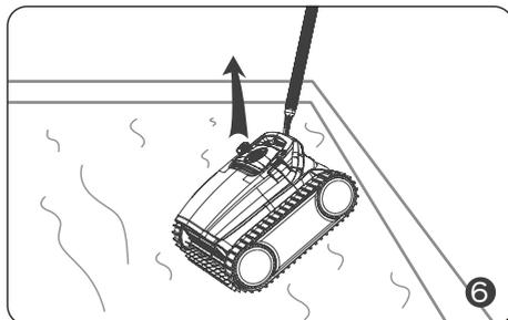
Sie können den mitgelieferten Haken an einer Pool-Stange befestigen und den Reiniger aus dem Pool heben.
